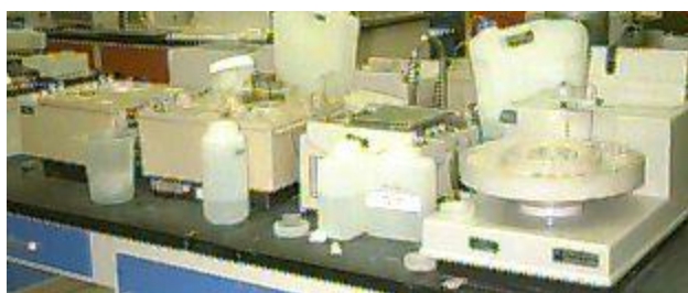
Εικόνα 1.17. Ένα από τα μοντέλα πολυκάναλων αναλυτών συνεχούς ροής της Technicon Corporation. Η τεχνολογία της Technicon πουλήθηκε στη Revlon το 1980 και κατόπιν στη Bayer σημερινή Siemens Diagnostics.
