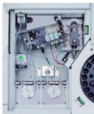
Εικόνα 1.9α. Δεξιά ηλεκτρόδια ISE σύγχρονου βιοχημικού αναλυτή και αριστερά η θέση τους μέσα στον αναλυτή.
