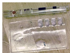
ACA. Πακέτο εξέτασης με binary code σε μια ράβδο στην κορυφή. (Du Pont - Dade Behring - Siemens)
