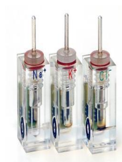
Εικόνα 1.9α. Δεξιά ηλεκτρόδια ISE σύγχρονου βιοχημικού αναλυτή και αριστερά η θέση τους μέσα στον αναλυτή.
